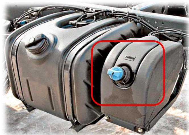
**i** Принцип работы системы SCR состоит в химической реакции окиси азота, содержащейся в выхлопных газах, с аммиаком. Реагент AdBlue® выполняет роль носителя аммиака. **В результате такой реакции образуются полностью безвредные водяные пары и азот.**
